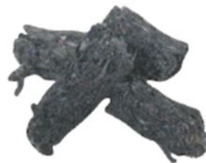
ケミカルリサイクルの原料となるプラスチック固形物 (RPF)
