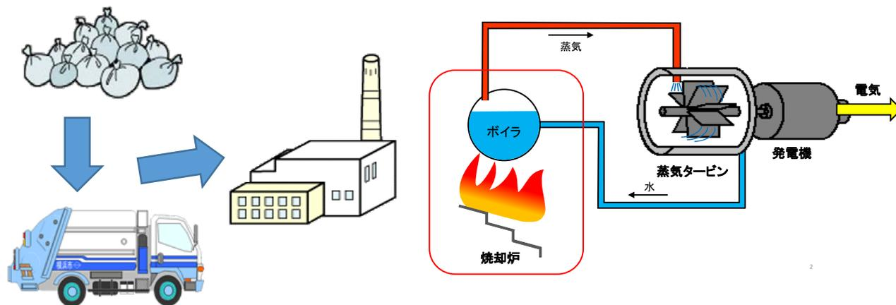
焼却工場における発電の仕組み
