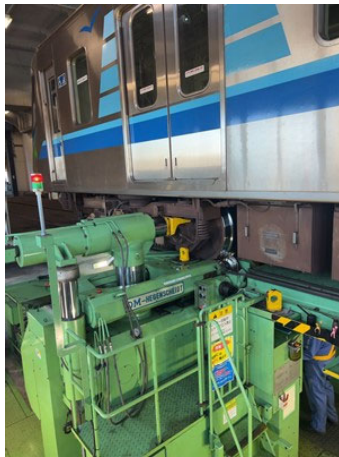
在姿車輪旋盤(転削盤)
