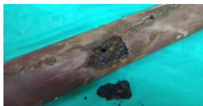
【劣化により埋設配管の損傷部分】
