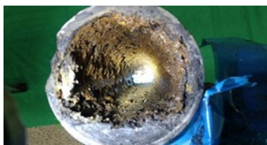
【閉塞した污水配管内部】
