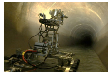
中大口径管用 TV カメラの例
