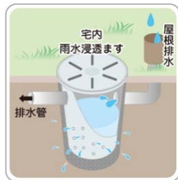
宅内雨水浸透ます
