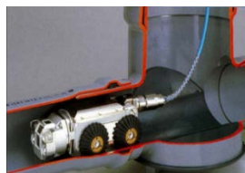
下水道管のTVカメラ調査 水再生センター等の運転管理
