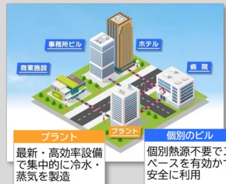
地域冷暖房の仕組み
