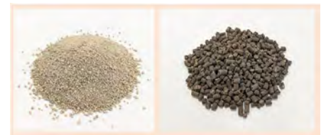
下水汚泥から回収した再生リン（左） 再生リン入り肥料（右）
