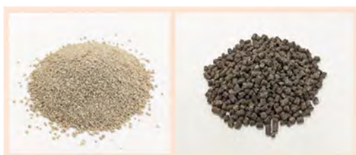
下水汚泥から回収した再生リン（左）と 再生リン入り肥料（右）
