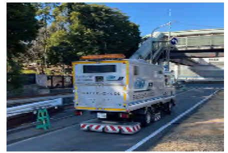
空洞探査車による 路面下空洞調査の様子
