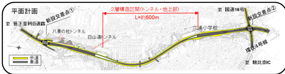
横浜逗子線（釜利谷六浦地区）の平面・縦断計画・標準断面図
