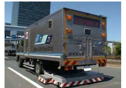
空洞探査車による調査
