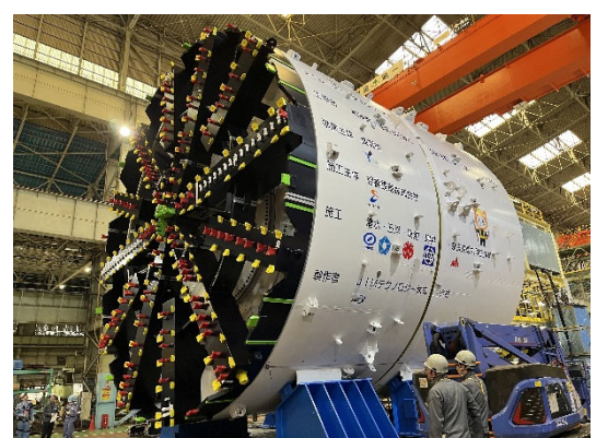
シールドマシンの工場製作(仮組)状況 (直径:10.7m)
