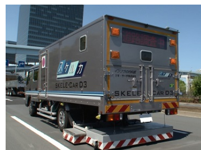
空洞探査車による調査
