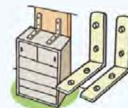
Prevenção de queda de móveis
