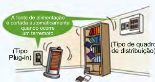
Disjuntor detector de terremotos
