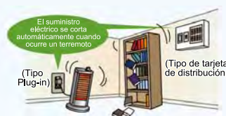
Interruptor detector de terremotos
