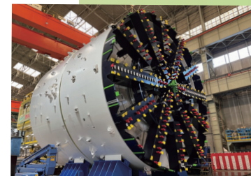
工場でのシールドマシン仮組立検査
