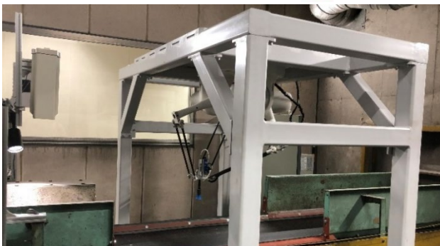
金沢資源選別センターに設置された AI 自動選別ロボット
