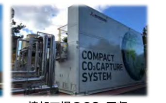
焼却工場のCO 2 回収(CCUの実証試験)
