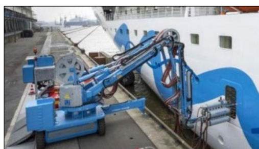
【ハンブルク港におけるクルーズ船への陸上電力供給の様子】
