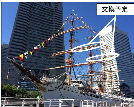
【交換を予定しているヤード（2箇所）】
