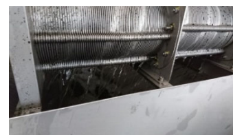
汚泥脱水装置で汚泥が固液分離されている様子 ©アムコン株式会社
