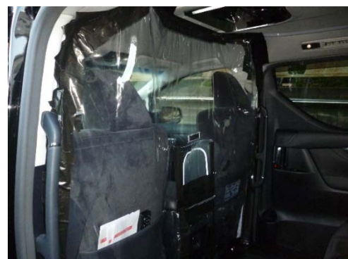
※ 移送車両の内装<仕切り設置>
