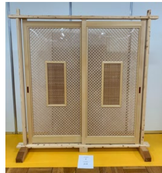
七宝トンボとねじ組を取り入れた 中抜き組子入り硝子戸
