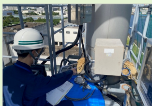
事業所への立入検査 (排出ガス測定)
