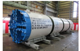
シールドマシン （中和田雨水幹線）
