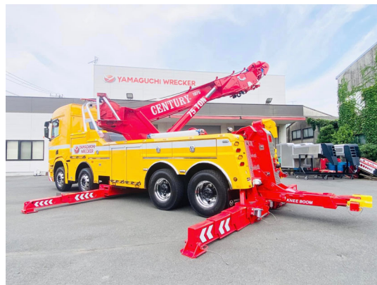
75t の吊り上げ能力を有する 国内最大の大型レッカー車
