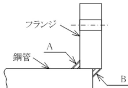
原則として鋼製品（フランジ部を含む）とし、接水部はJWWA K 135、JWWA K 157に基づくエポキシ樹脂塗装を施す。
