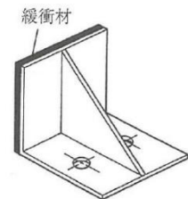
補強L形プレート形
