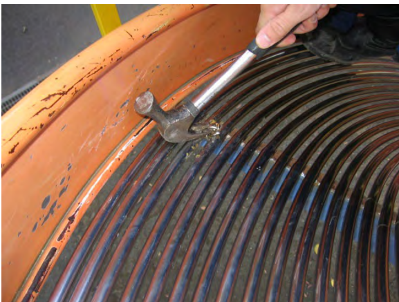
図 2-20 隙間にチェーンがはさまった例
