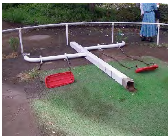
図 2-8 一本支柱構造のブランコの事故例
