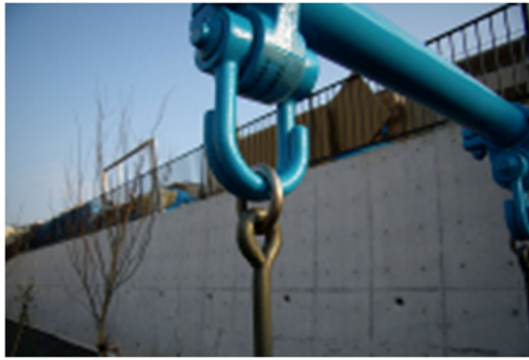
図 2-2 1 吊金具と吊チェーンの間にリングを入れた例
