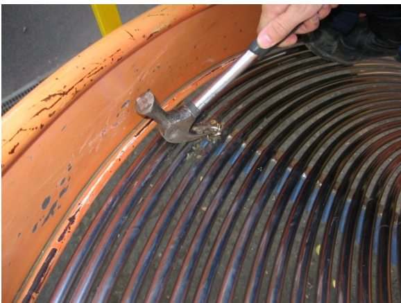
図 2-20 隙間にチェーンがはさまった例
