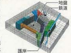
図4 みなとみらい地区における広域地盤3次元FEMモデル実施例
