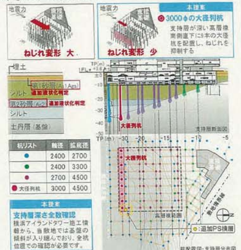
図3 傾斜地盤に対する基礎計画
