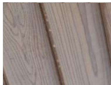
写真 4-21 防火処理木材の液垂れ
