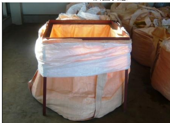
■フレームのフレコン設置状態
