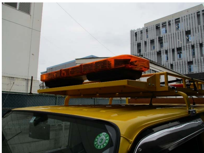
別添⑨ 散光式回転灯 ※地上高2,300mm以下とする（高さ制限道路通行のため）
