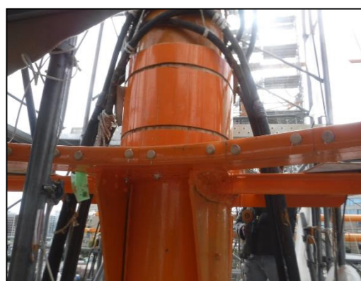
ジガーマスト・トップボード上 バッテン材（静索用当て木）交換
