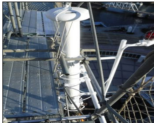
ミズン・ゲルンマスト ポール及びマストトラック塗装
