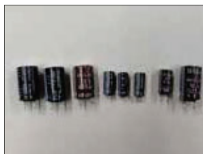
破損コンデンサー交換
