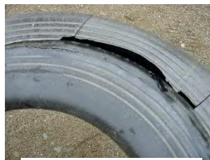
ゴム系素材の劣化状
