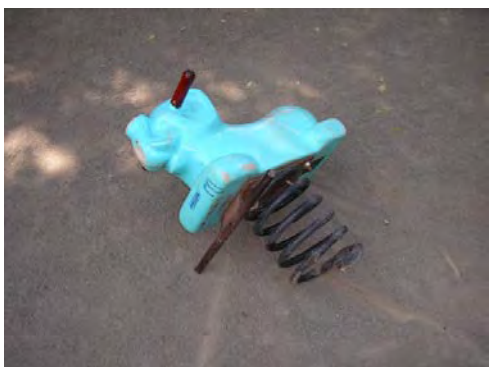
▲ スプリングの破損
