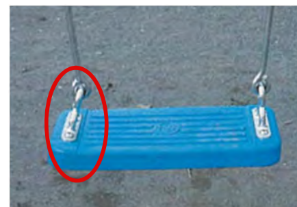
▲ 座板を固定する吊り金具の変形 内部の鉄板の不具合の可能性 (吊り金具が座板から外れる可能性もある)
