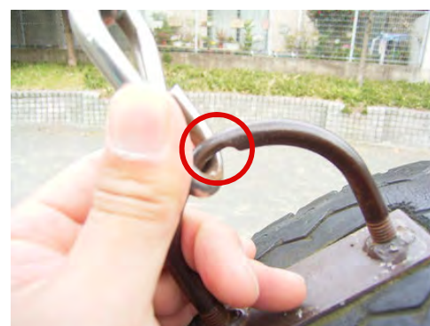
▲ タイヤ取付リングの摩耗
