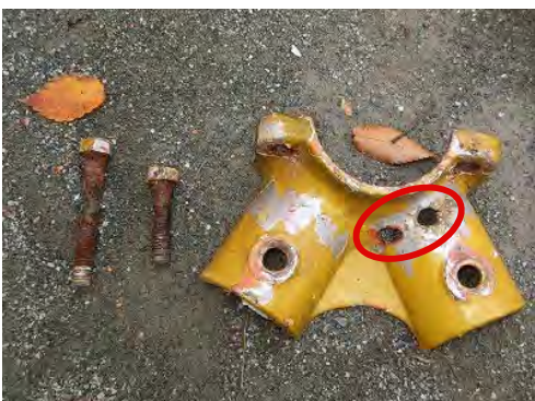
▲ ブランコ支柱継ぎ手金具（鋳物）の穴
