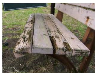
腐朽の中期段階
