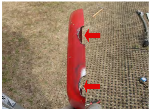
▲ 滑車カバー側面の摩耗（写真は分解後のもの）
