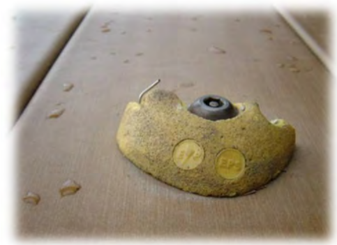
▲ クライムホールドの破損
