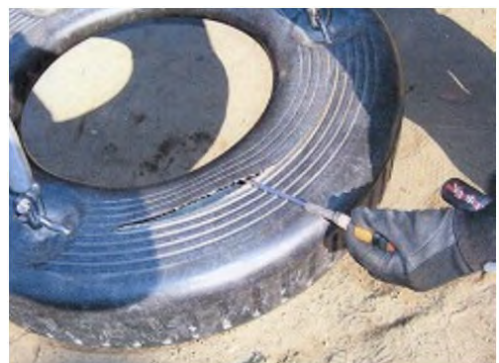
▲ 座面(タイヤ)の破損
