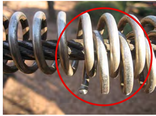
▲ 緩衝部（スプリング）の破損
