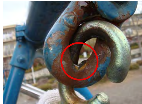
▲ 吊り金具の摩耗
