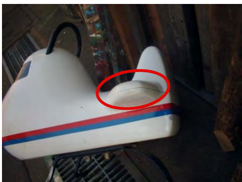
▲ 本体の亀裂（FRP製）
