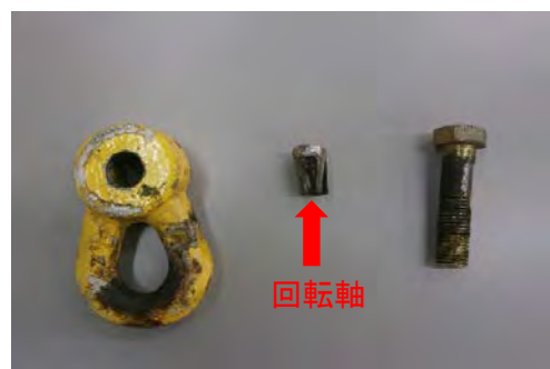
▲ 回転軸の破損
