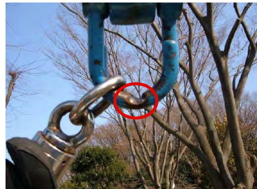
▲ 上部吊金具摩耗
