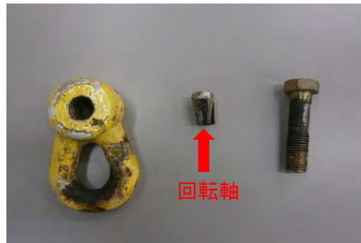
▲ 回転軸の破損
