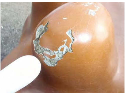
▲ 本体表面の破損
