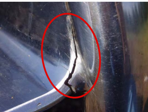
▲ 滑り降り部端部の亀裂
