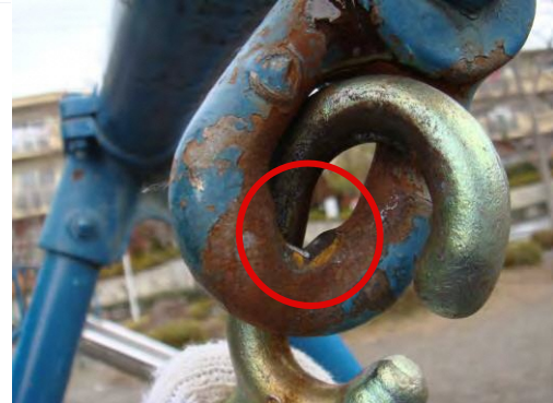
▲ 吊金具の摩耗
