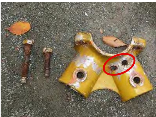
▲ ブランコ支柱継ぎ手金具（鋳物）の穴
