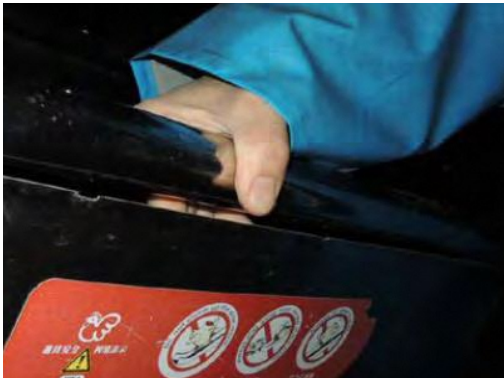
▲ ブランコ側板の溶接部破損
