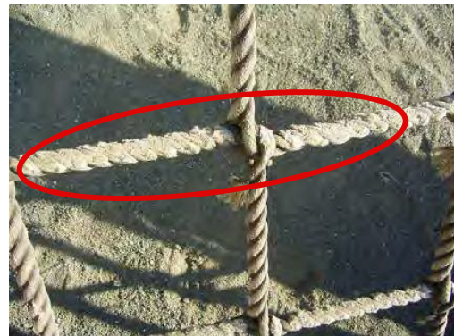
▲ ネットの破損・摩耗
