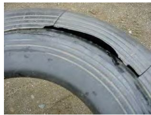
ゴム系素材の劣化状
