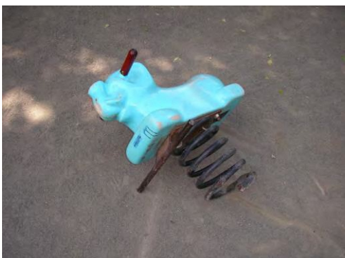
▲ スプリングの破損
