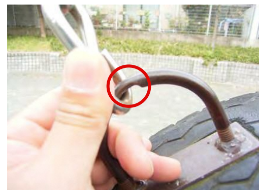
▲ タイヤ取付リングの摩耗
