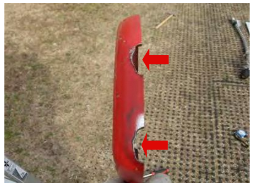
▲ 滑車カバー側面の摩耗（写真は分解後のもの）
