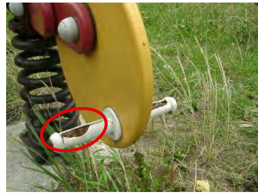
▲ 足掛部の損傷
