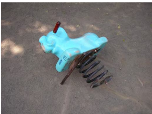
▲ スプリングの破損
