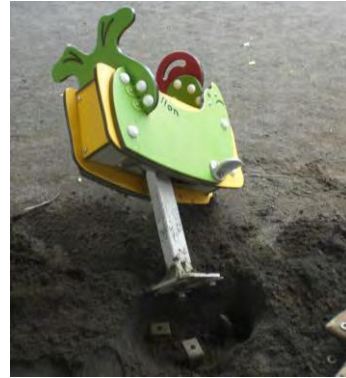
▲ ボルト欠損、アンカープレート破断
