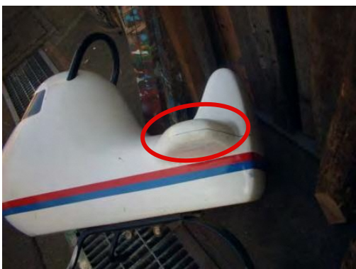
▲ 本体の亀裂 (FRP製)
