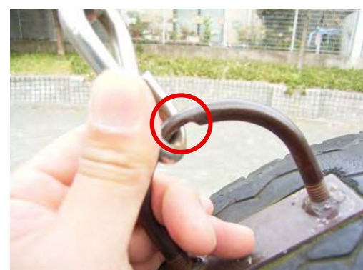
▲ タイヤ取付リングの摩耗
