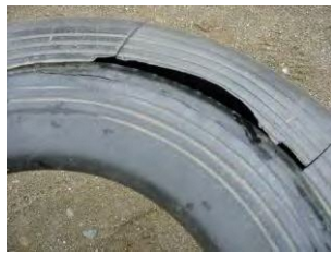
ゴム系素材の劣化状
