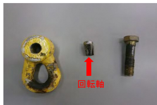
▲ 回転軸の破損
