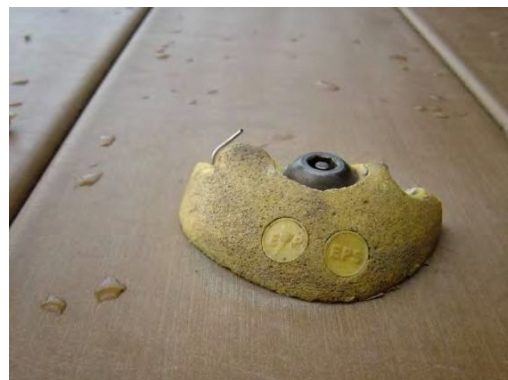
▲ クライムホールドの破損
