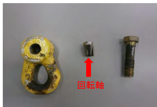
▲ 回転軸の破損
