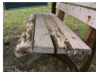
腐朽の中期段階
