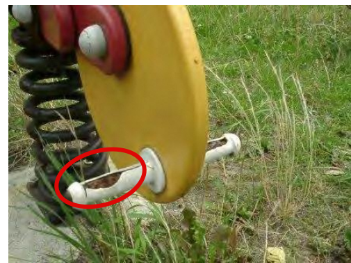
▲ 足掛部の損傷
