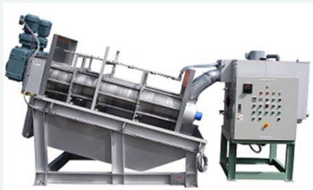
民間工場等への汚泥脱水装置の納入(フィリピン・メトロセブ等) アムコン(株)(港北区)
