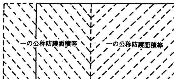
図9 防護対象物が大きく一の装置で警戒できない場合
