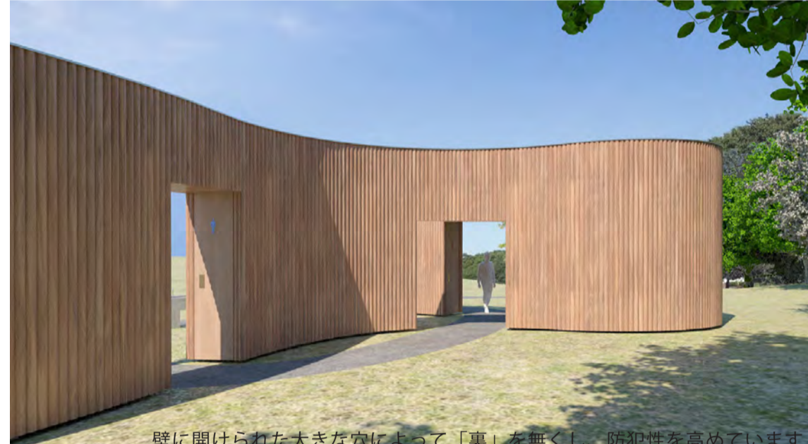
壁に開けられた大きな穴によって「裏」を無くし、防犯性を高めています
