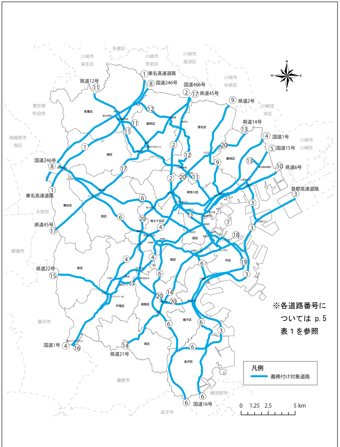
図1 耐震診断を義務付けた道路（震災発生時に通行を確保すべき道路のうち「特に重要な道路」）
