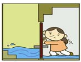
水圧でドアが開かない
