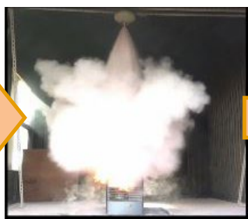
出火から約1分後、消火薬剤放射
