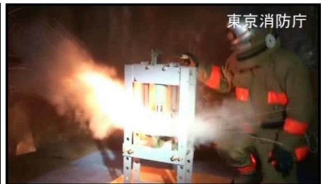
図7 リチウムイオン蓄電池を圧潰
