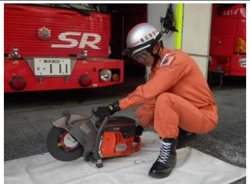
始動後、「**後ろハンドル**」を握り、「**スロットル**」を全開にしてエンジン回転を安定させる。
