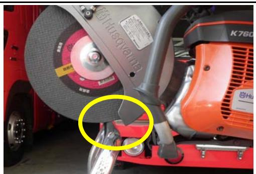
「保護カバー」は下端が切断物に出来るだけ接近するよう角度を調節する。
