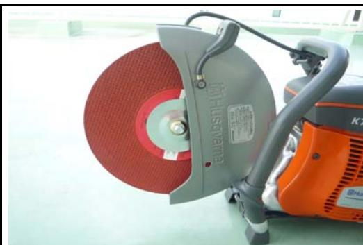
使用後、「切断刃」の状態を確認する。
