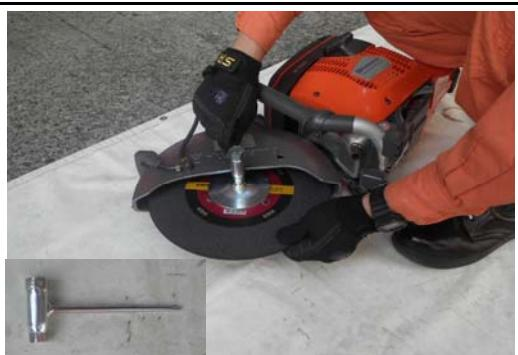
「専用レンチ」を使い、「切斷刃」を押さえながら中心のネジを回す。
