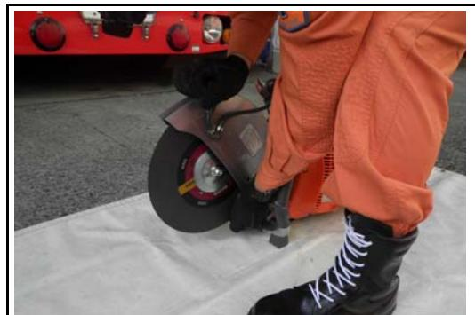
「調整ハンドル」と「保護カバー下部」を握り、切断中操作員に火花が掛からない適正な角度に調整する。
