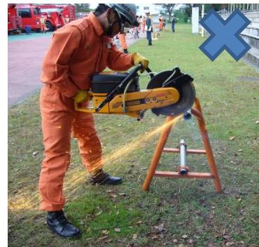
適切な角度(保護カバー下端を切断物に出来るだけ接近させる)に
