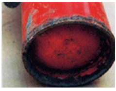
錆や塗装の剥離
