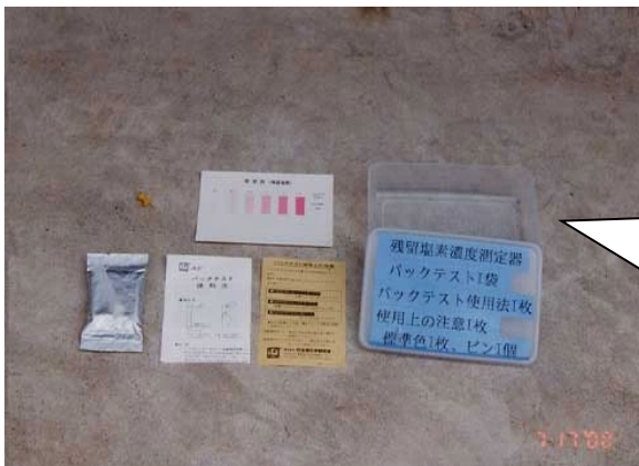
(6) 残留塩素濃度測定器 (パックテスト1袋、パックテスト使用法1枚、パックテスト使用上の注意1枚、標準色1枚、ピン1個)
