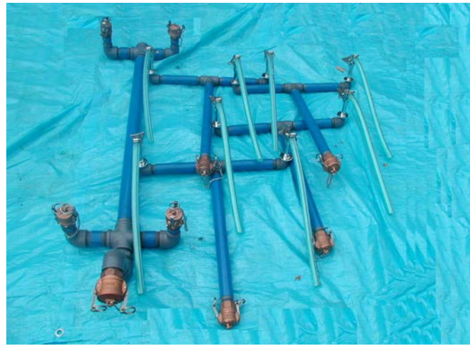
応急給水装置.....2組 (蛇口数...8栓×2組)
