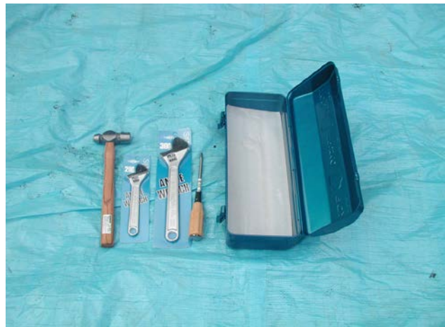
工具セット.....1式 工具箱1個、ドライバー (-) 1個、金槌1個、 モンキースパナ (小) 1個 (大) 1個
